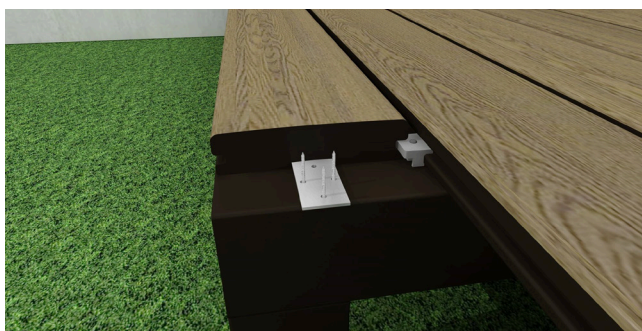
A2 principe de pose du connecteur pour lame Nature
